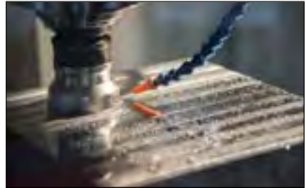
Fresatura ad alti avanzamenti
