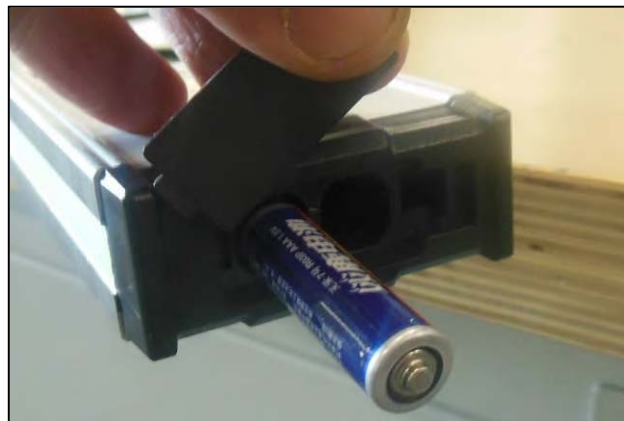
Figura 3 – Sostituzione della batteria.
